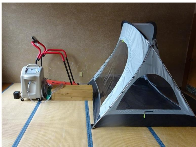
写真1 低酸素トレーニング装置一式
